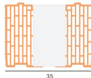
Muratura da tamponamento a fori verticali ad incastro con inserto in EPS ad ALTE PRESTAZIONI TERMICHE
